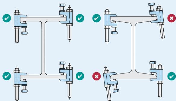
➤ Bei Schrägflanschprofilen muss die Ringschneide der Schraube immer auf der geneigten Flanschseite greifen.
