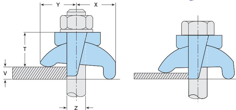
Hinweis 1: Bei der Montage darauf achten, dass die gerade (nicht die schräge) Seite des Sattelanschlags am Flansch anliegt.
