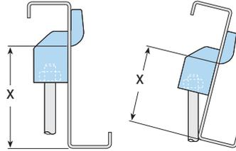
**Position der Bohrung an geneigten Pfetten**
