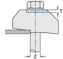
Sphäroguss, Flachstahl, feuerverzinkt.
